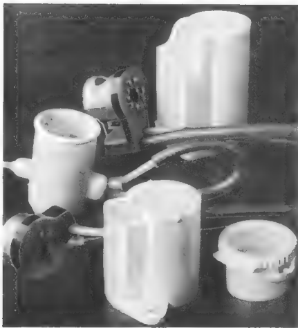
Bild 11. Einige Hochspannungsfassungen für Reparaturzwecke. Im Vordergrund eine für fast alle Zeilen-Transformatoren passende Ausführung. Die hintere Garnitur benötigt etwas mehr Platz und neue Befestigungslöcher. Die mittlere Garnitur kann nur durch Zerlegen des Transformators angebracht werden
